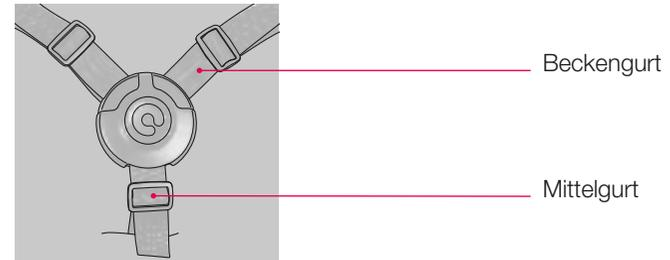
Führen Sie den Mittलगurt mit dem Gurtschloss zwischen den Beinen des Kindes hindurch. Stecken Sie anschließend die Gurtschloss-Adapter des Beckengurts von oben in die entsprechenden Aufnahmen des Gurtschlusses und lassen Sie diese hörbar einrasten.
