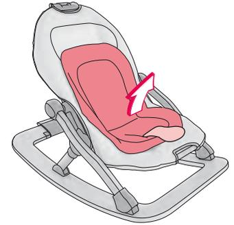
Um den Bezug abzunehmen, klappen Sie den CONCORD RIO ganz zusammen. Öffnen Sie den Klettverschluss unterhalb des Entriegelungshebels (06) an der Rückseite der Rückenlehne. Danach können Sie den Bezug einfach vom Rohgestänge abziehen.
