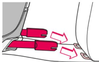
Oba adaptéry TWINFIX (10) nasuňte na úchytky ISOFIX ve vozidle tak, aby fixační mechanismy slyšitelně zaklapnuly.
