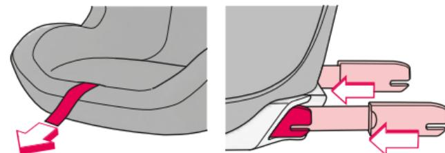
Centrální pás TWINFIX (08) táhněte dopředu tak, aby se adaptéry TWINFIX (10) zcela zasunuly!
