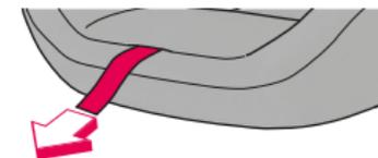
Desplazar hacia adelante el cinturón central TWINFIX (08) y llevar el CONCORD TRANSFORMER hacia atrás hasta que éste apoye lo más posible sobre el respaldo del asiento del vehículo.
