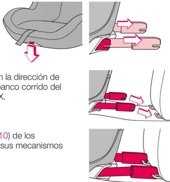
Colocar el CONCORD TRANSFORMER en la dirección de la marcha sobre el asiento individual o el banco corrido del vehículo dotado con los enganches ISOFIX.
