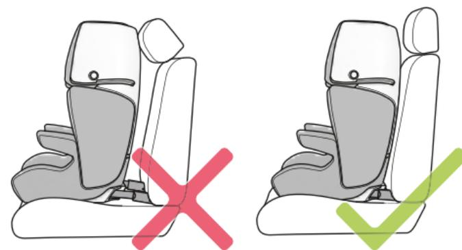
Tirez la sangle centrale TWINFIX (08) vers l'avant et reculez le CONCORD TRANSFORMER jusqu'à ce qu'il soit placé tout contre le dossier du siège auto.
