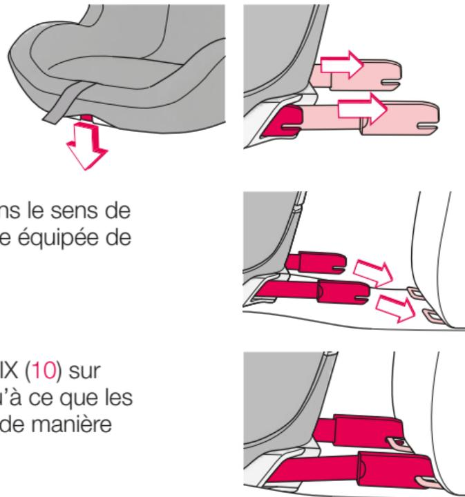
Placez le CONCORD TRANSFORMER dans le sens de la marche sur le siège auto ou la banquette équipée de supports ISOFIX.
