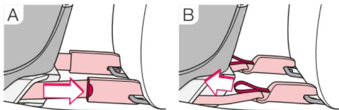
Débloquez les adaptateurs TWINFIX (10) de manière à ce que les crochets de sécurité s'ouvrent et que les adaptateurs soient éjectés.
