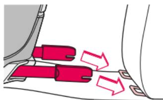
Empurre ambos os adaptadores TWINFIX (10) em direcção aos pontos de apoio ISOFIX no veículo, até os mecanismos de fecho encaixarem de forma audível.
