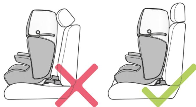
Puxe o cinto central TWINFIX (08) para a frente e desloque o CONCORD TRANSFORMER para trás, até encostar o mais e melhor possível no encosto do banco do veículo.
