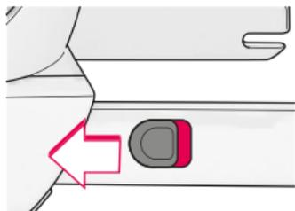
Zum Demontieren des CONCORD TRANSFORMER, ziehen sie den Bedienknopf TWINFIX (09) nach vorn und bewegen Sie den Sitz ganz nach vorn. Ziehen Sie nun die Sicherungsknöpfe an den Außenseiten der TWINFIX-Adapter (10) nach vorn, bis die Sicherheitsanzeigen rot sind. Ziehen Sie nun den Sitz nach vorn von den ISOFIX-Aufnahmen ab.
