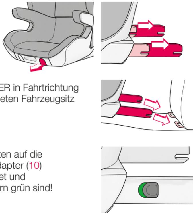
Stellen Sie den CONCORD TRANSFORMER in Fahrtrichtung auf den mit ISOFIX-Aufnahmen ausgestatteten Fahrzeugsitz bzw. Sitzbank.
