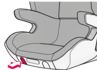
Um die Neigungsregulierung des CONCORD TRANSFORMER zu Verwenden drücken Sie den Bedienknopf Sitzneigung (04) an der Vorderkante des Sitzes.
