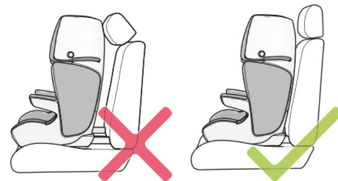
Bei Fahrzeugen mit Serienkopfstütze kann durch Verstellen bzw. Demontage dieser Kopfstütze ein besserer Einbau des Sitzes erzielt werden. Beachten Sie, dass die Fahrzeugkopfstütze wieder in der korrekten Position eingebaut werden muss, wenn ein Erwachsener mitreist.
